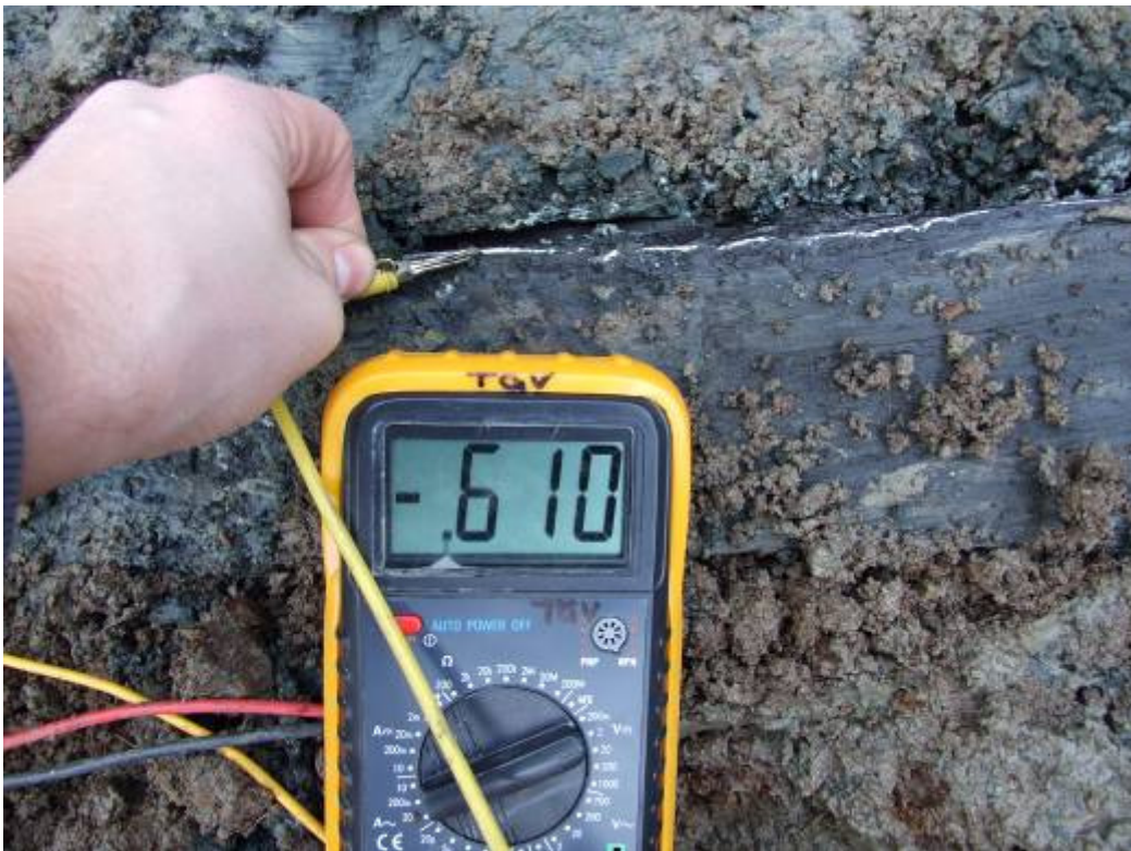
Figur 3.3 Mätning av korrosionspotential hos plattstång av kolstål i omgrävd jord på provningsplats Göteborg. Med korrosionspotential menas potentialskillnaden (spänningen) mellan en korroderande metall och en referenselektrod.
