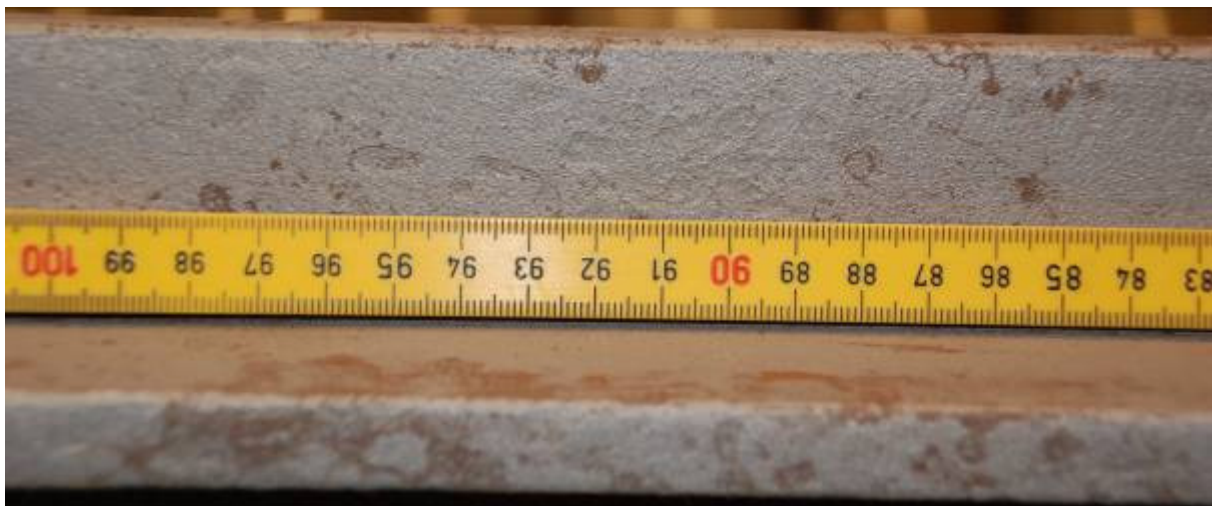
Figur 5.13 X-påle (påle nr 11), som exponerats neddriven i naturligt lagrad jord på provningsplats Göteborg under 27,4 år. Djupet under markytan till tryckplattan var 0,5 m. Tumstocken på bilderna visar avståndet från tryckplattan. Medelkorrosionshastigheten för hela pålen var 6,9 \mu\text{m}/\text{år} .
