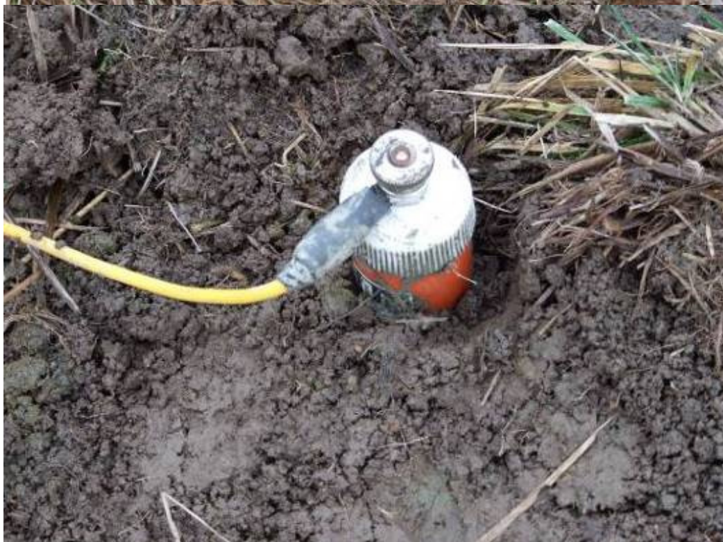
Figur B.2 Mätning av redoxpotential i naturligt lagrad jord på provningsplats Stockholm, Skå. Mätsond och referenselektrod.
