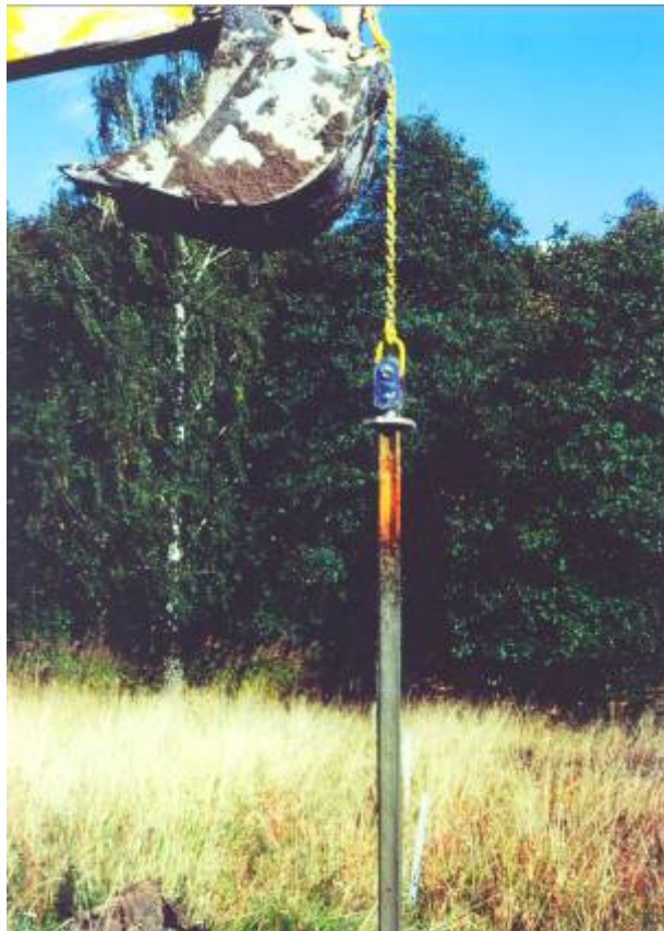
Figur 2.4 Uppdragning av X-påle vid provningsplats Sollentuna efter fem års exponering i lera. Lägga märke till rödrosten på den övre delen av pålen och den mörka nedre delen färgad av gyttjig lera.
