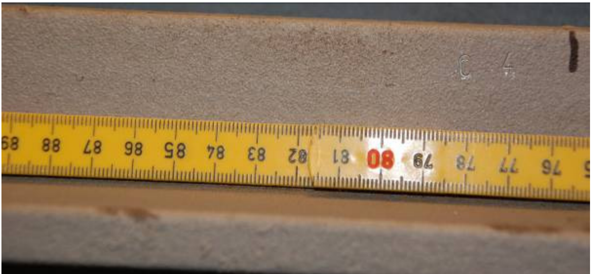
Figur 5.12 X-påle (påle nr 26), som exponerats neddriven i naturligt lagrad jord på provningsplats Sollentuna under 26,9 år. Djupet under markytan till tryckplattan var 0,49 m. Tumstocken på bilderna visar avståndet från tryckplattan. Medelkorrosionshastigheten för hela pålen var 7,8 \mu\text{m}/\text{år} .
