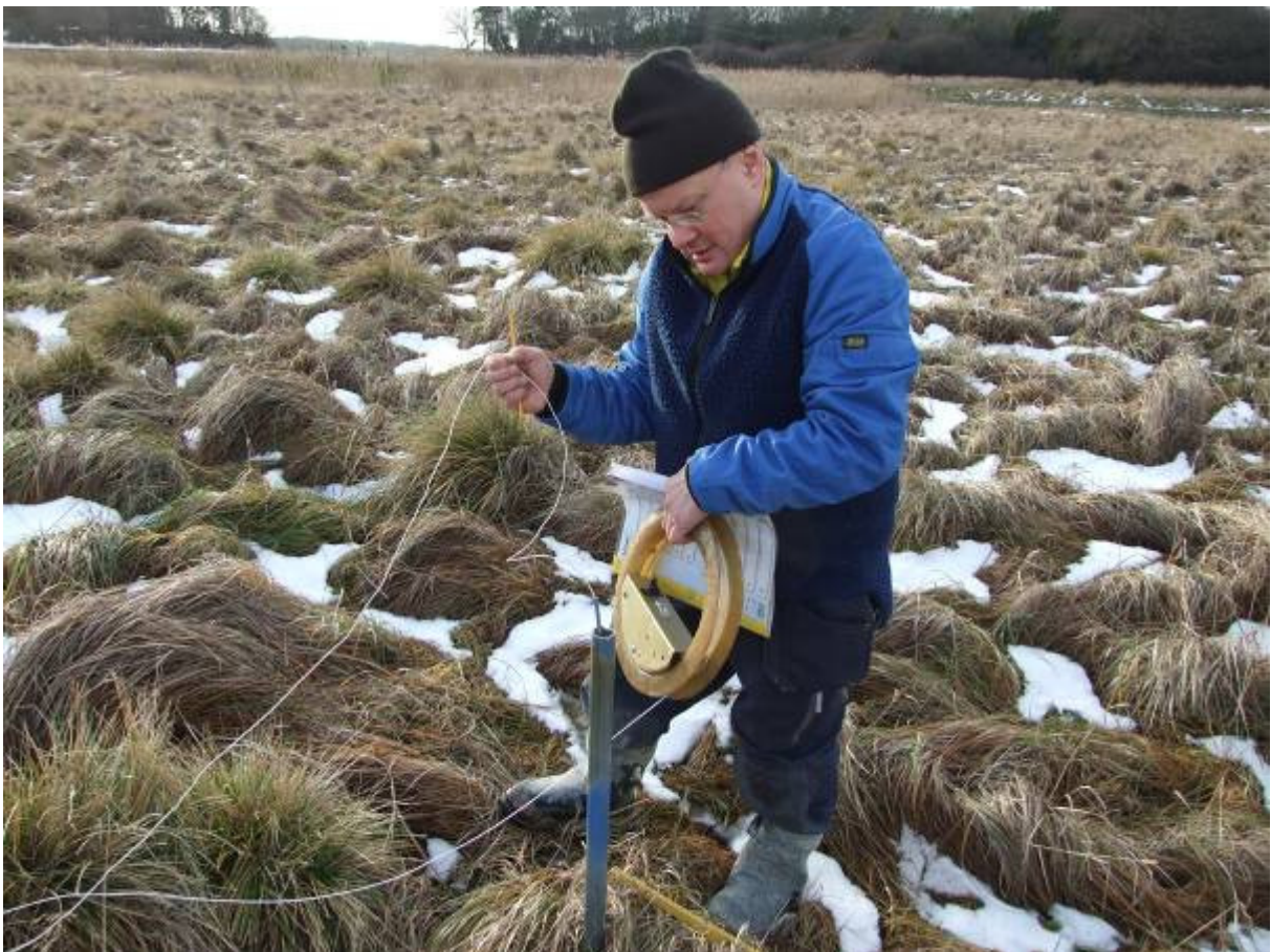
Figur 3.4 Mätning av grundvattennivå i naturligt lagrad jord på provningsplats Stockholm, Skå. Mätningen sker i rör med filterspets. Filterspetsen trycks ned med hjälp av förzinkade stålrör. Filterspetsen är förbunden med en plastslang, som utgör stig- och mätrör för grundvattnet. Avläsning av vattennivån i plastslangen utförs med en elektrisk dubbelledare (vit tunn kabel) kopplad till ett elektriskt avläsningsinstrument. Dubbelledaren sänks ned i slangen och ger utslag på instrumentet när ledaren når vattenytan. Djupet mäts på den vita sladden.
