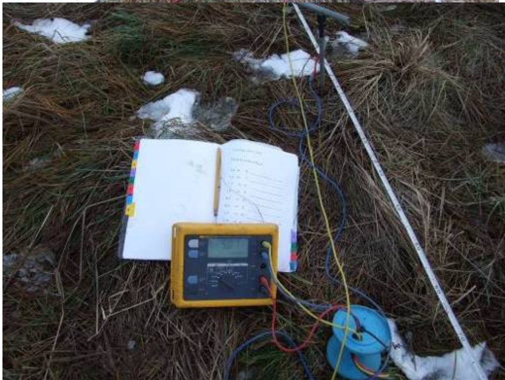
Figur 3.1 Mätning av jordresistivitet i naturligt lagrad jord med Wenners 4-elektrodmätning på provningsplats Stockholm, Skå.
