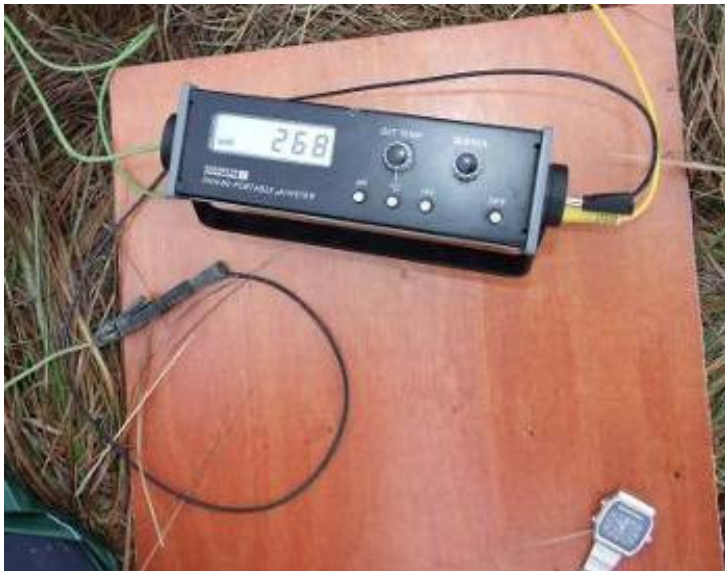
Figur B.1 Mätning av redoxpotential i naturligt lagrad jord på provningsplats Stockholm, Skå. Med redoxpotential menas potentialskillnaden (spänningen) mellan en inert elektrod (vanligtvis en platinaelektrod) och en referenselektrod.
